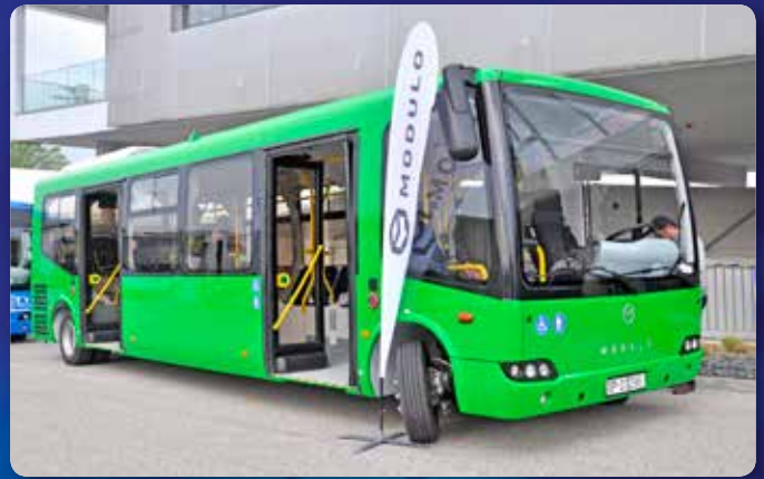
A kompozit karosszériás Modulo midibusz immár sűrített földgázzal (CNG) üzemelő változatban is elérhető
