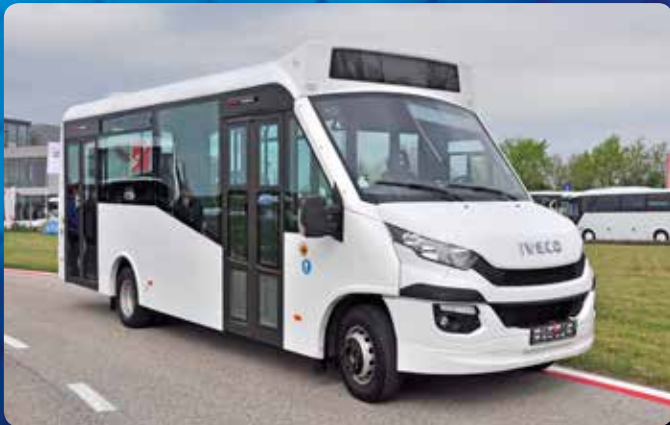
Egy cseh gyártó felépítményezte ezt az alacsonybelépésű városi buszt IVECO Daily 70-es alvázra
