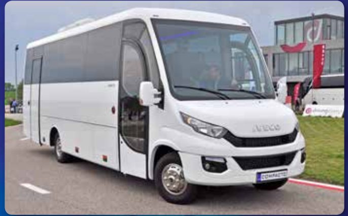
Az IVECO Compacto 2 midibuszt a Kapos Járműgyártó Zrt. felépítményezi IVECO Daily 70-es alvázra
