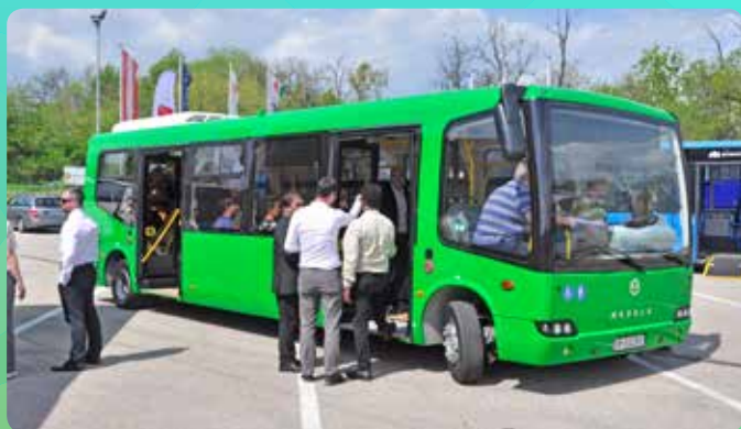
Elkészült a Modulo kompozit karosszériás midibuszának sűrített földgázzal (CNG) hajtott prototípusa
