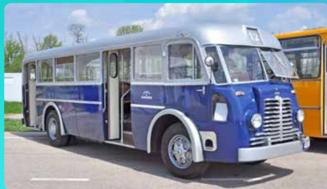
Hetven évvel ezelőtt készült ez a 22+1+1 üléses MÁVAG TR5, amelyet 105 lóerős Láng dízelmotor hajt
