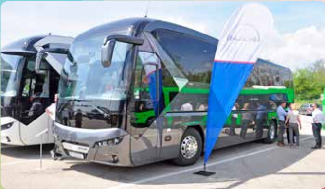
Ez a NEOPLAN Tourliner P21 típusú, 12,1 méteres, kéttengelyes modell is egyedi kivitelű csapatbusznak készült
