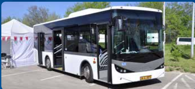
Isuzu Citibus Euro 6 9,5 méter hosszúsággal, 4,5 literes, 213 lóerős Cummins motorral, akár 25 ülő- és 44 állóhellyel
