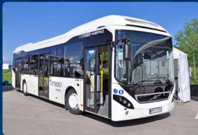
A Volvo 7900 Hybrid Euro 6 dízel-elektromos hajtású, a svéd gyártó már nem is kínál hagyományos dízelüzemű városi buszokat
