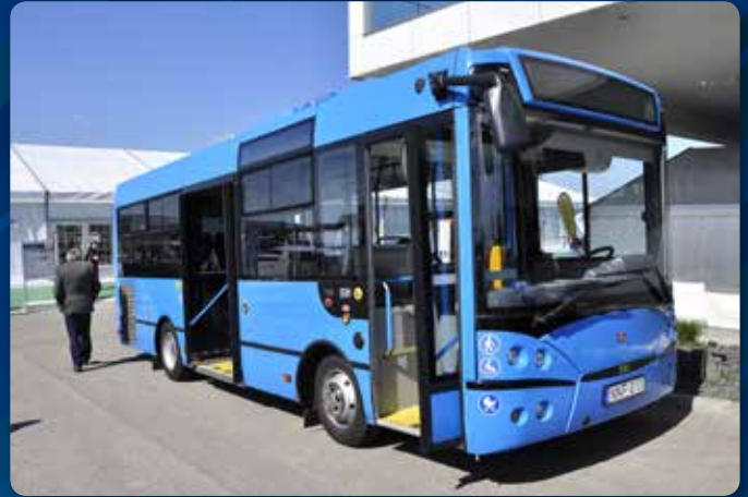
Rába S91 midibusz, 7,9 méter hosszúsággal, 4,25 literes, 156 lóerős Mercedes-Benz Euro 6-os dízelmotorral, 19 ülő- és 24 állóhellyel
