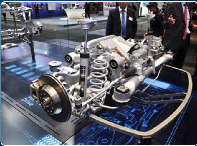
Kompakt elektromos hajtásrendszer kishaszonjárművekhez a ZF-től
