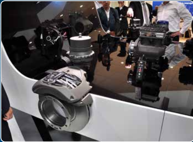
Knorr-Bremse Synact kétugattyús fék nyerges vontatóknak
