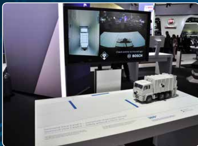
Bosch Surround View EasyFit: madártávlati képet adó körkörös kamerarendszer tehergépkocsikra
