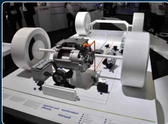
Bosch komplett elektromos hajtásrendszer többek között kishasznójárművek számára
