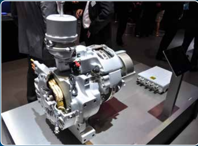
A ZF AxTrax AVE elektromos hajtású portáltengely kerékagymotorja
