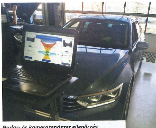
Radar- és kamerarendszer ellenőrzés
